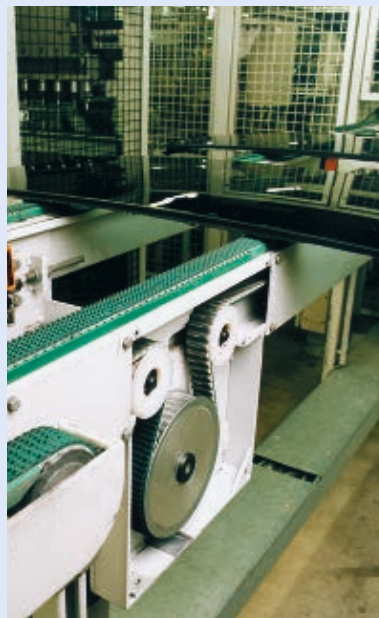
通过皮带的同步运行输送轿车车窗。同步带带背的包覆层不但增加了摩擦力，而且不会对输送物造成损害。
